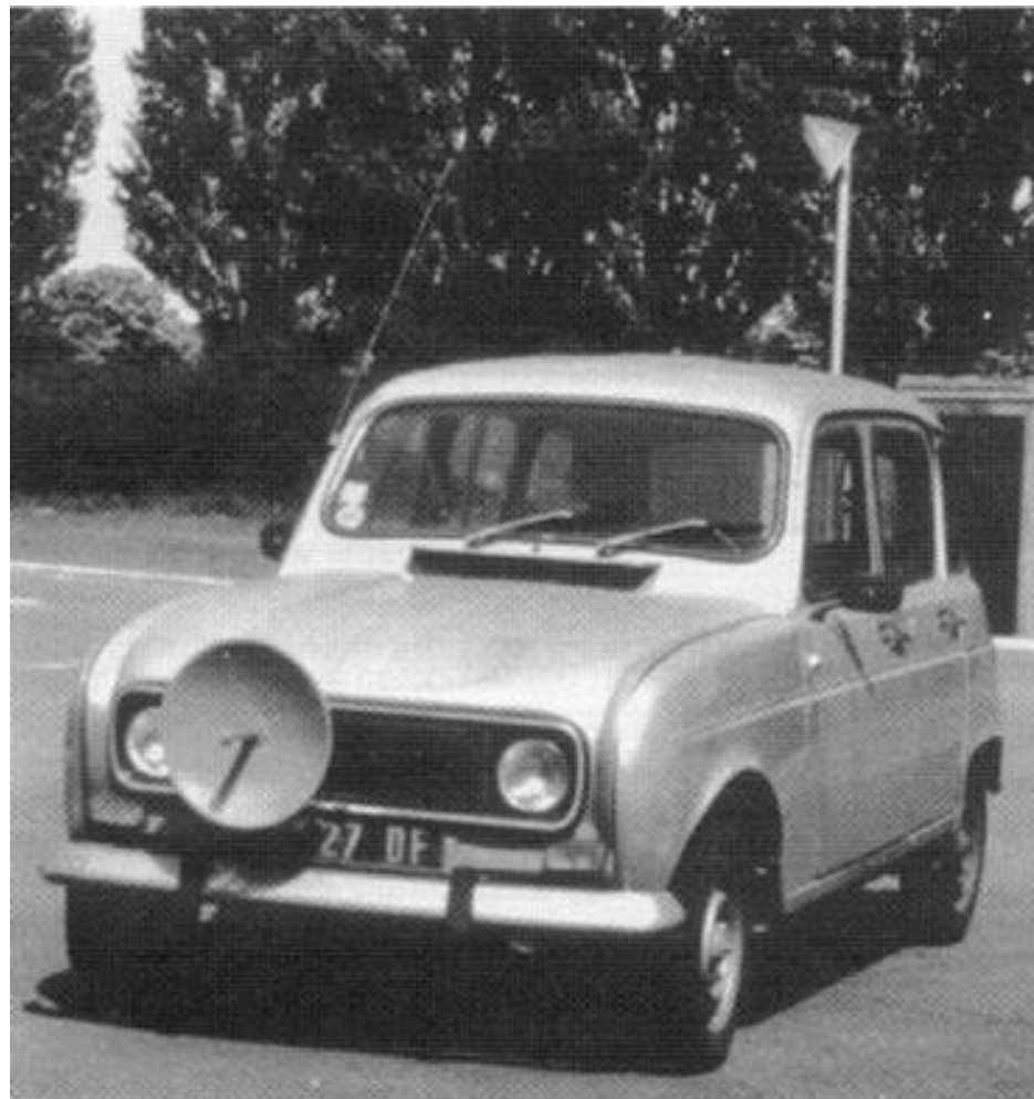
Véhicule d'essai Renault 4L embarquant une maquette de radar anti collision.
